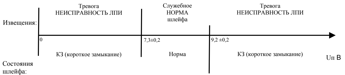
Рисунок Д.2 – Структура шлейфа контроля ЛПИ
