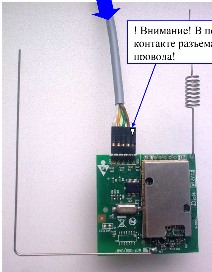
Плата MCR-300 Visonic подключена к плате Лунь-11
